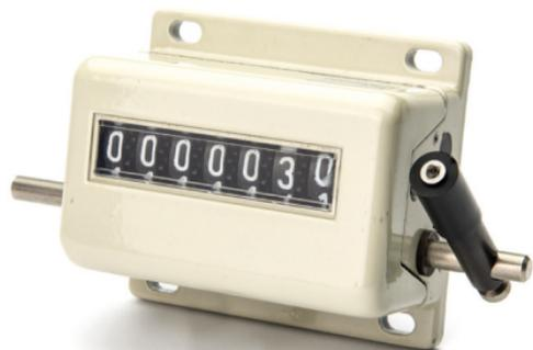
**Descrizione****7 cifre altezza 8 mm - albero D.7 mm - comando bilaterale.****Con azzeratore a chiave.****Senso di rotazione: 0 = orario, S = antiorario.****Velocità massima di conteggio: 500 colpi al minuto.****Misure di ingombro: 92x80x50.**
