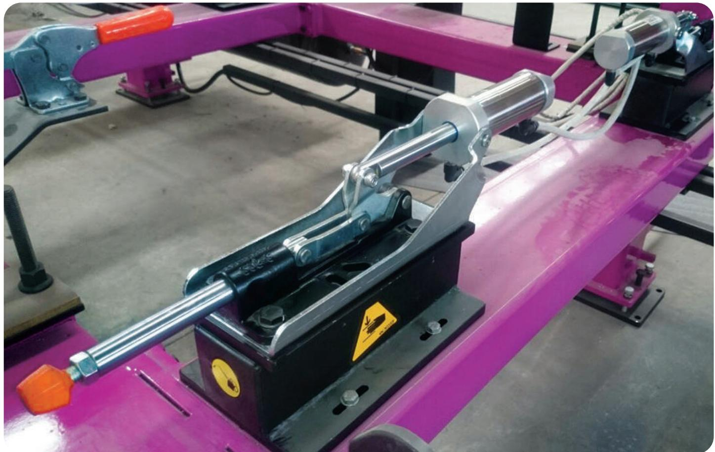
**Cilindro pneumatico a doppia azione: magnetico e con ammortizzatore**
